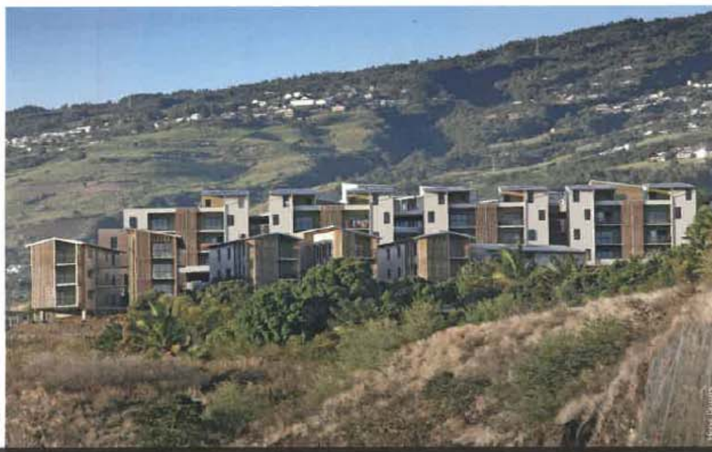
La végétation rafraîchit par évapotranspiration et limite les surchauffes par rayonnement du sol.
